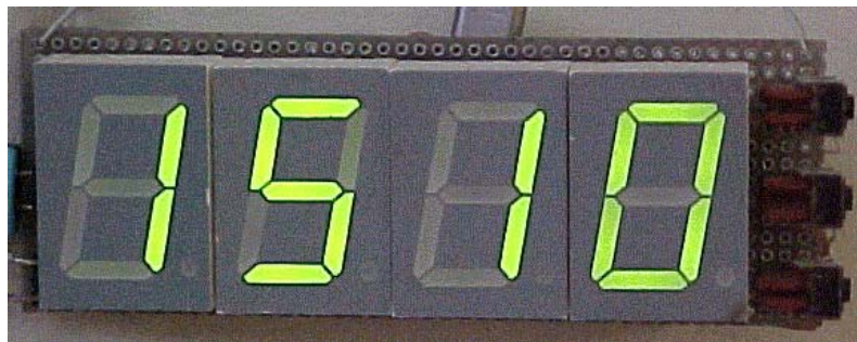
Fig.3-15 Ceas electronic montat pe placă prototip
