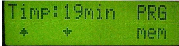
fig.3-10 Meniul programare timp, but1, but2 și but4 sunt active, semafor = galben
